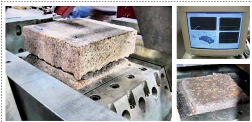
Figura 8 – Máquina de deslizamento de diáclases
