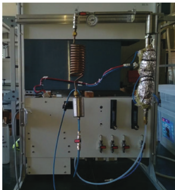
Figura 4 Aspeto do reator catalítico de leito fixo no Laboratório de Tecnologia Química do ISEL
