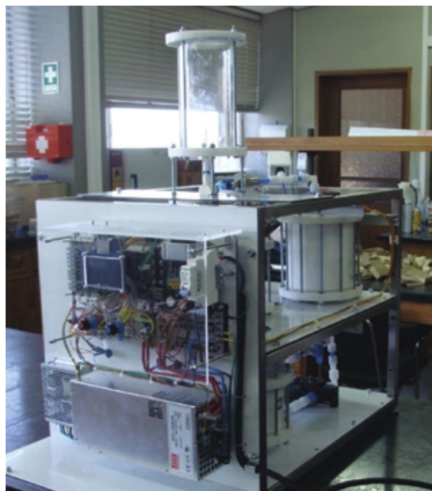
Figura 3 Aspeto do eletrolisador de 1 kW no Laboratório de Tecnologia Química do ISEL
