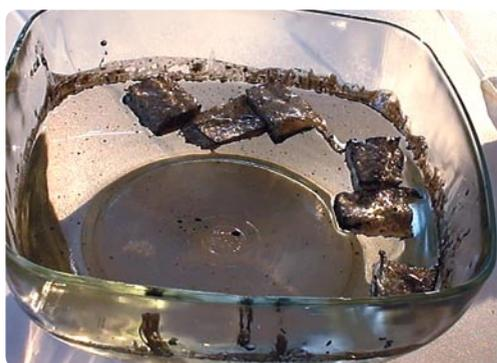
Demonstração da absorção de óleo pela espuma de poliuretano desenvolvida: derrame de óleo em água; processo de absorção de óleo; água após alguns minutos
