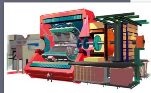
No âmbito de uma colaboração, designada por ALICE, está a ser construído um detector de iões pesados dedicado, que lhe herda o nome, para exploração do potencial físico único das interações núcleo-núcleo ocorridas nos processos de energia do LHC. O objectivo é estudar a física da matéria que interage fortemente sob densidades extremas de energia, onde a formação de uma nova fase da matéria, o plasma *quark-gluon*, é esperada.
